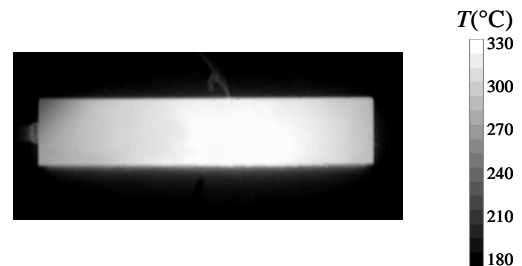
Figure 2 : Température de surface obtenue par thermographie infrarouge
