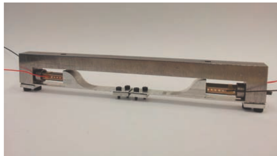
Figure 5 : Actionneur piézoélectrique amplifié de Amokrane et al. [2] (20cm de long)
