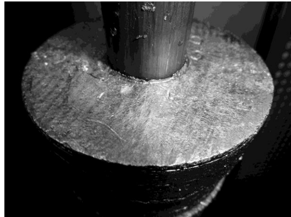
Figure 3 : Photo d'une couronne de GNE+MCP placée autour du tube de cuivre
