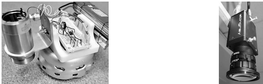
Figure 4 : Robot Khepera-III équipé d'un pyromètre et Caméra Stingray F-046C
