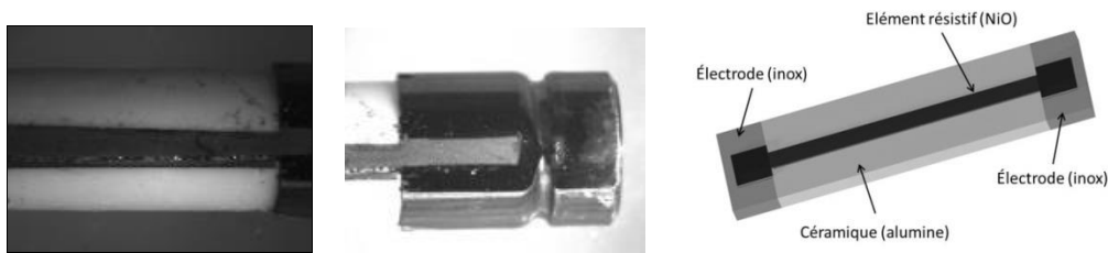
Figure 7 : Représentation du substrat métal/céramique sur lequel est déposé un élément résistif
