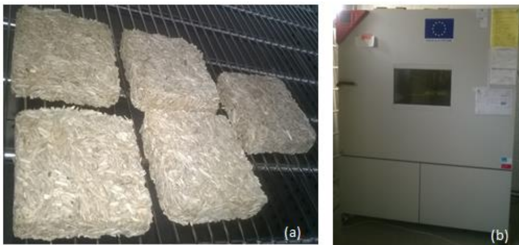
Figure 1: (a) Photographie des échantillons, (b) Enceinte climatique Binder MKF 720.
