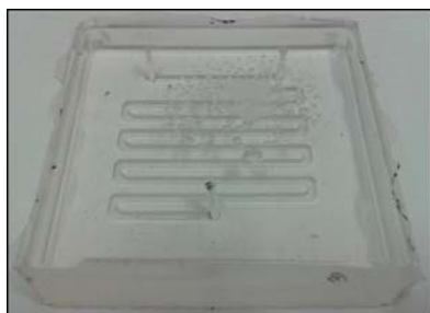
Figure 5 : Microréacteur en T réalisé en PDMS (longueur 216mm)
