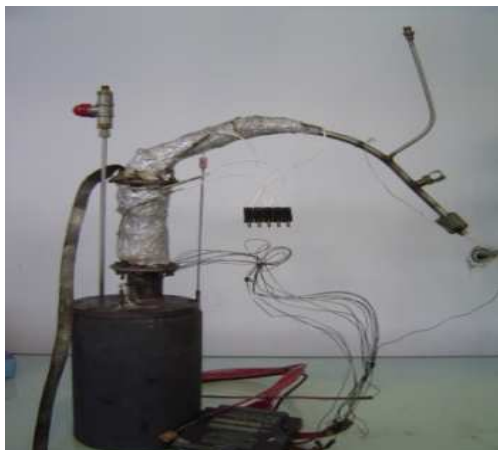
Figure 1 : Pyrolyseur utilisé (GEPEA, Ecole des Mines de Nantes)
