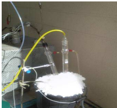
Figure 2 : Système de condensation
