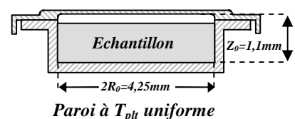
Figure 2 : Cellule porte-échantillon du calorimètre
