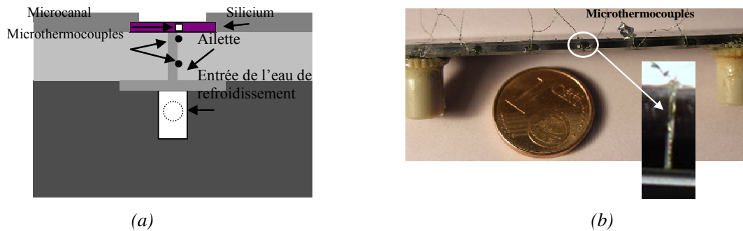
Figure 2. Section d'essais expérimental : (a) Section d'essais, (b) Instrumentation du microcanal par des microthermocouples.
