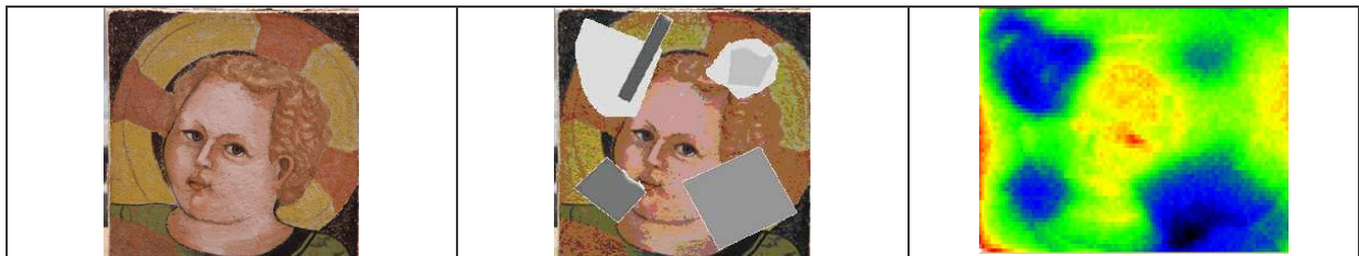
Figure 5 : La mini fresque étudiée (à gauche), la position des défauts internes (au centre) et un exemple de résultats photothermique aléatoire obtenu (à droite)
