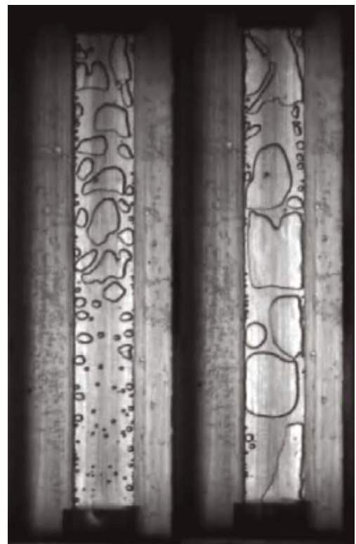
Fig. 5 : Structures d'écoulement pour D_H = 0,84 \text{ mm} en hypergravité (à gauche) et microgravité (à droite) ( Q_w = 32 \text{ kW/m}^2 , Q_m = 95 \text{ kg.s}^{-1}.\text{m}^{-2} )
