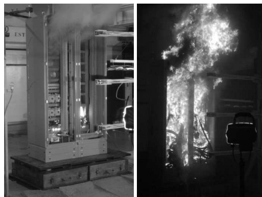
Figure 2 : Phases d'inflammation et de feu pleinement développé lors de l'essai PXA.3.1
