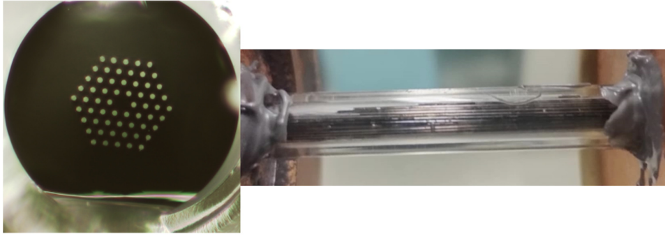
Figure 1 : Échantillon utilisé dans ce travail. Gauche : extrémité d'une fibre et ses 60 microcanaux de diamètre 5.95\mu\text{m} ; droite : monolithe de 60 fibres de 5.9 cm de longueur fixé entre deux échangeurs sur le banc d'essais.
