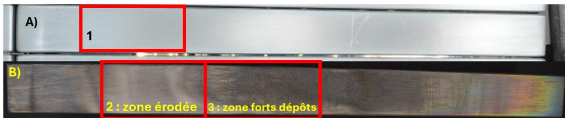
Figure 4 : Photo de composant interne avant (A) et après (B) exposition au plasma
