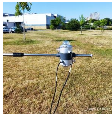
Figure 3b : Détail de la mise en œuvre des deux pyranomètres
