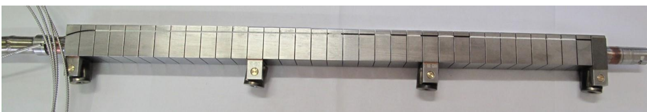
Figure 1 : Composant Type ITER équipé d'une FBG enfouie
