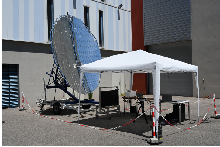
Figure 1 : Photographie du banc expérimental. Le réflecteur de Scheffler collecte le rayonnement solaire direct et le concentre sur la plaque en fonte qui observée à l'aide d'une caméra infrarouge.
