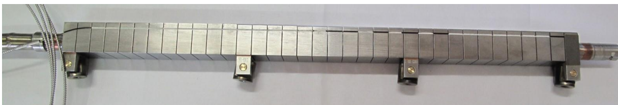
Figure 1 : Composant Type ITER équipé d'une FBG enfouie
