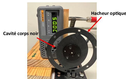
Figure 5 : Corps noir et hacheur permettant de produire un signal pseudo-sinusoïdal
