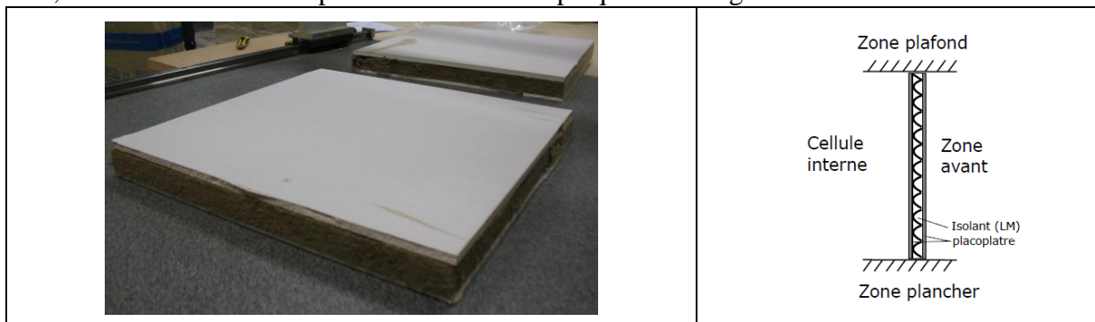
Figure 3 : Image du produit testé coupé en dimension de 600 \times 600 \text{ mm} pour être mesuré en plaque chaude gardée.
