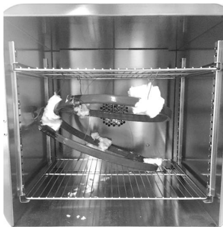
Figure 6 : Câble d'étude enroulé et maintenu dans l'enceinte thermique
