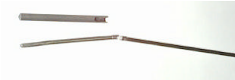
Carburation d'une tige en molybdène
