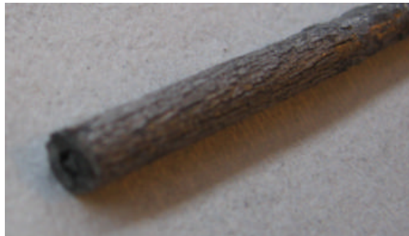
Carburation d'une tige en molybdène
