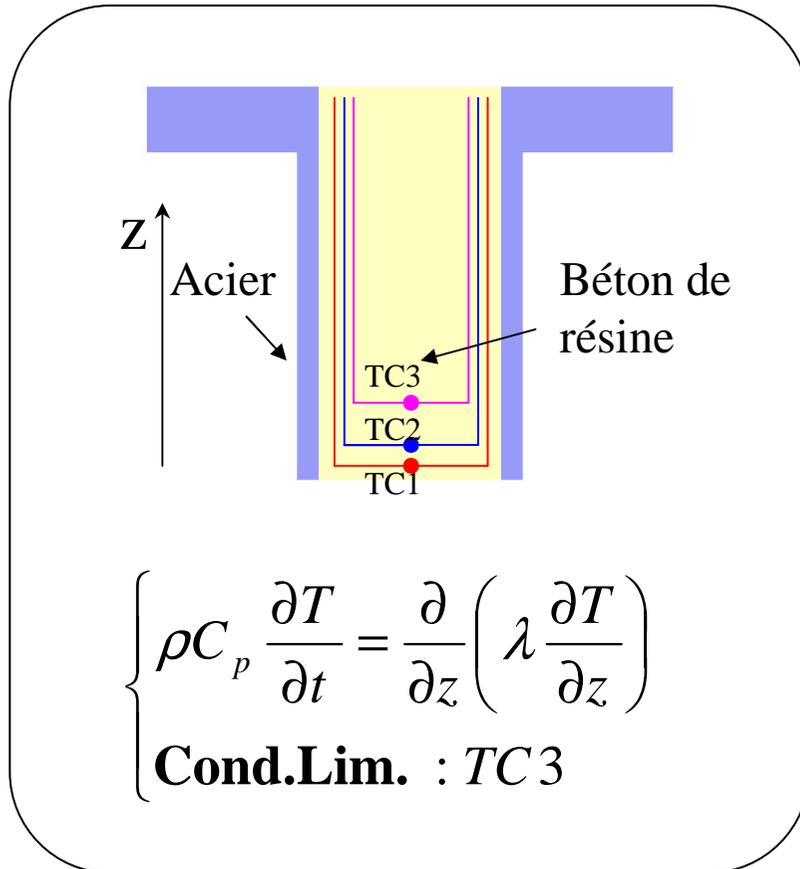
Détermination de la température de surface et du flux pariétal par la méthode de Beck (algorithme séquentiel) grâce à l'équation de conduction 1D.
