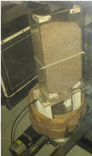
Silo modèle dans le tomographe
