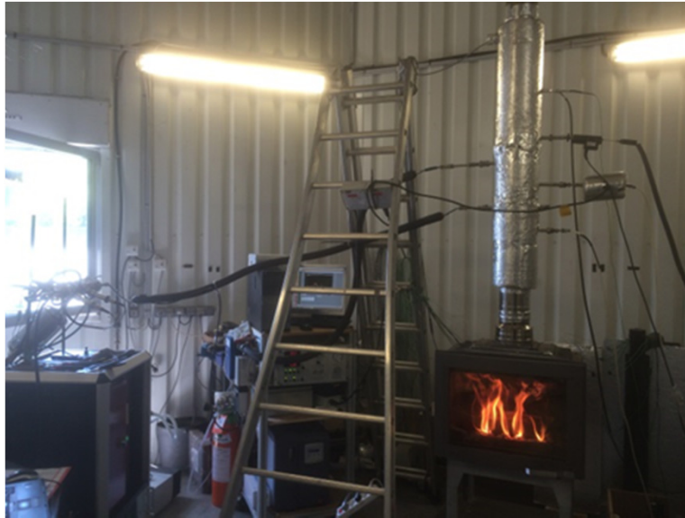
Plateforme LORFLAM tirage régulé 12 Pa
