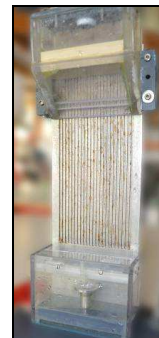
Figure 5 : Absorbeur adiabatique à plaque rainurée
