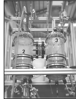
Figure 3 : Photographie du module désorption/condensation
